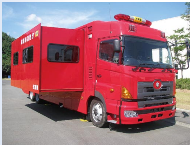
拡幅した外観
